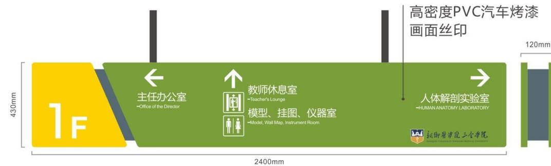
8mm高强度PVC雕刻底板造型，打磨烤漆处理，面贴5mm亚克力激光雕刻立体造型，背丝印背烤漆效果。
